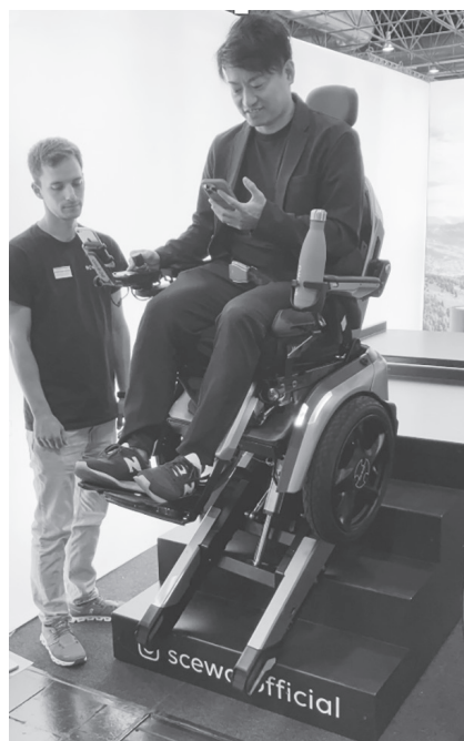
図4 スマートフォンで操作し 自分で階段を昇降できる車いす
